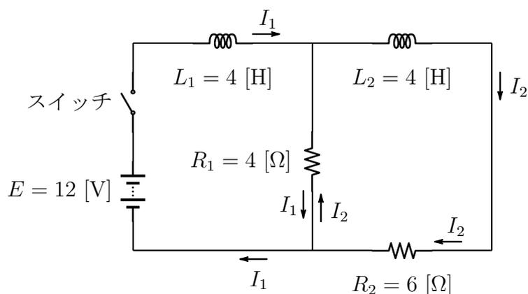
上記の回路で, 時刻  $t = 0$  にスイッチを入れたときの電流  $I_1(t)$ ,  $I_2(t)$  [A] を求めよ. ただし, スwitchを入れる前の回路中の電流はすべてゼロとする.
